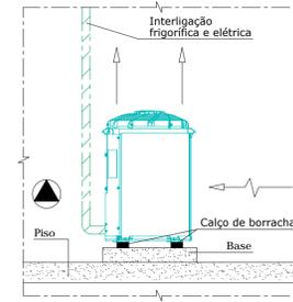
Detalhe Unidade Condensadora
