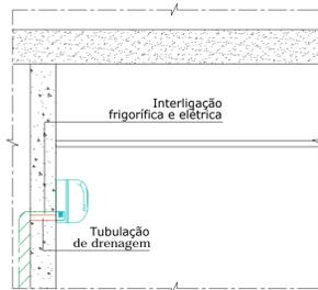
Detalhe Instalação de Split Hi-wall
